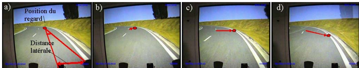
Figure 9 : Position du regard sur la route juste avant que le conducteur ne décide de corriger sa trajectoire. a) le conducteur regarde loin devant à l'intersection entre la direction de son déplacement et la partie extérieure de la route. b) à d) mouvement oculaire de contrôle le long de la limite extérieure de la route en direction du véhicule.
